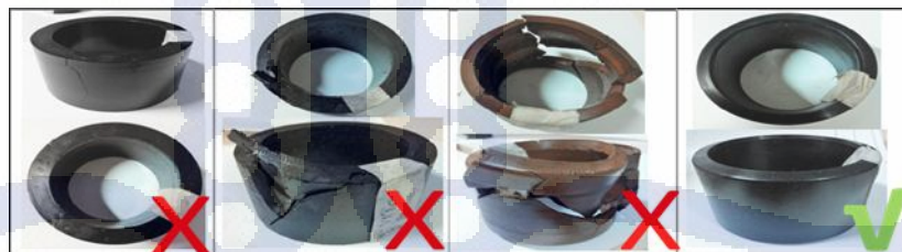
Gambar II.6 Kondisi pengujian material karet untuk Lapangan X (PT Abdi Patra Sejati, 2016)
