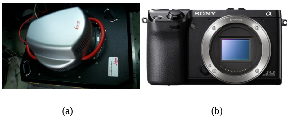
Gambar 2.4 Kamera metrik merek Leica PAV80 (a) dan kamera non-metrik merek Sony Nex-7 (b)
