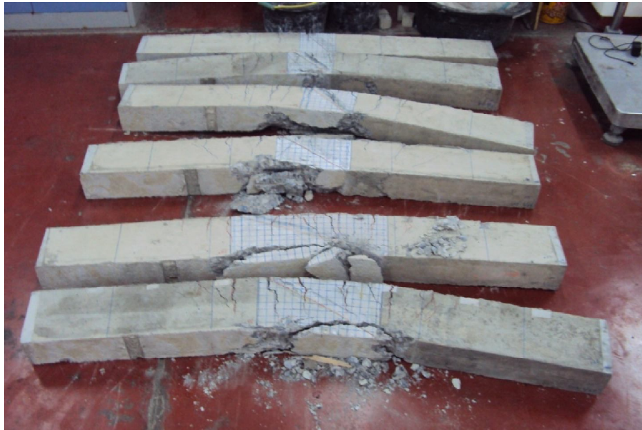
Gambar 6. 6 Kondisi balok pasca-pengujian
