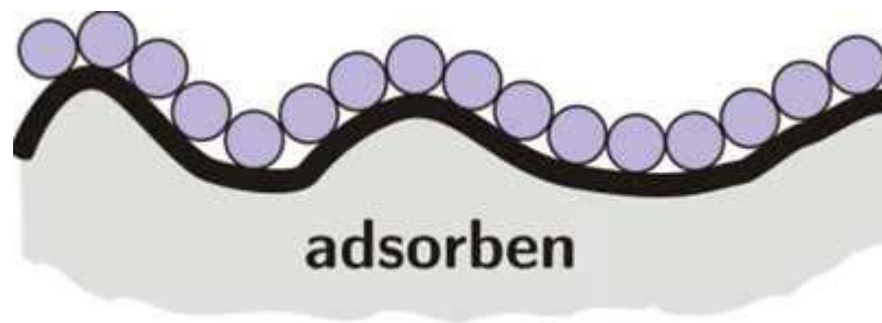
Gambar 5 Ilustrasi teradsorbsinya inhibitor pada permukaan logam
