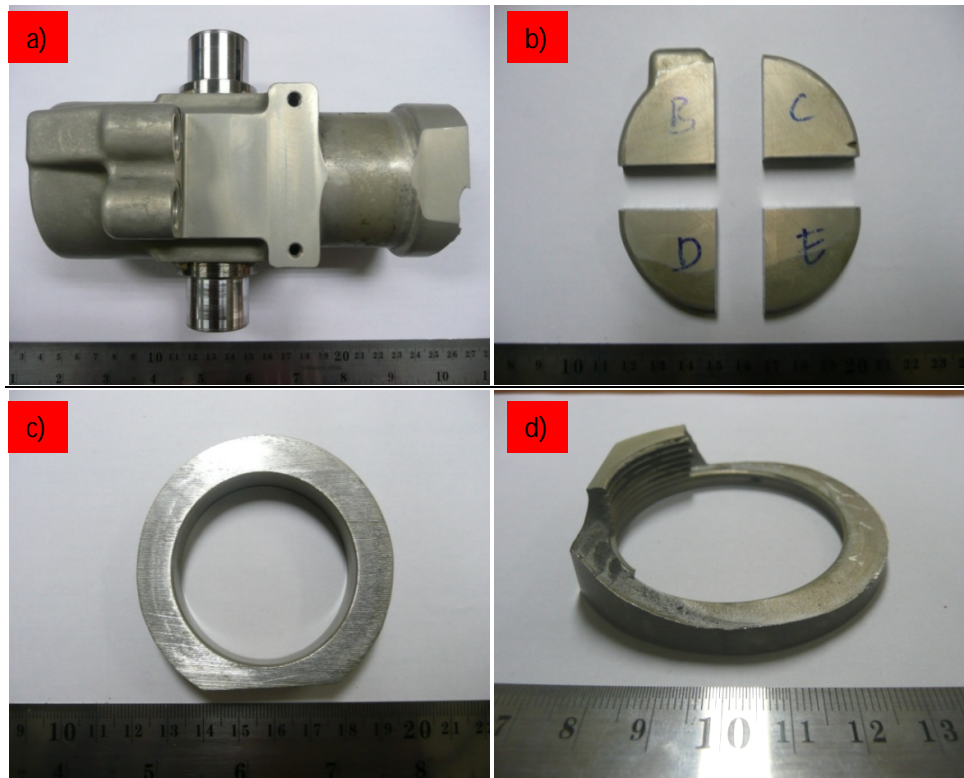
Gambar 3.4. Persiapan sampel: a) Aktuator sebelum pemotongan. b) Bagian bawah aktuator dibagi menjadi empat spesimen, bagian B, C, D, dan E. c) Bagian F, spesimen yang berasal dari bagian di bawah permukaan patah d) Bagian G mengandung permukaan patah yang digunakan pada pengamatan fraktografi
