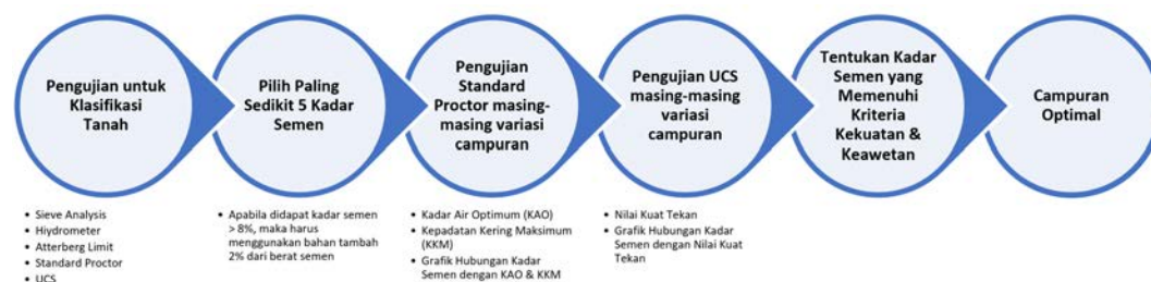
Gambar II.5 Konsep Perancangan Campuran Tanah Semen Spesifikasi Umum Bina Marga (2018)
