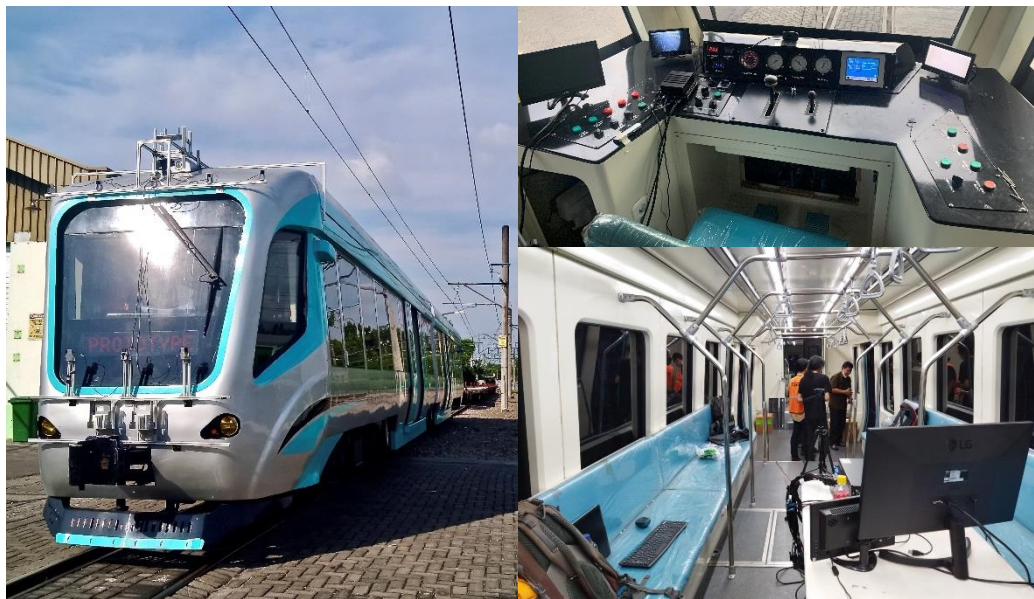
Gambar II.1. Trem baterai yang menjadi kendaraan uji.
