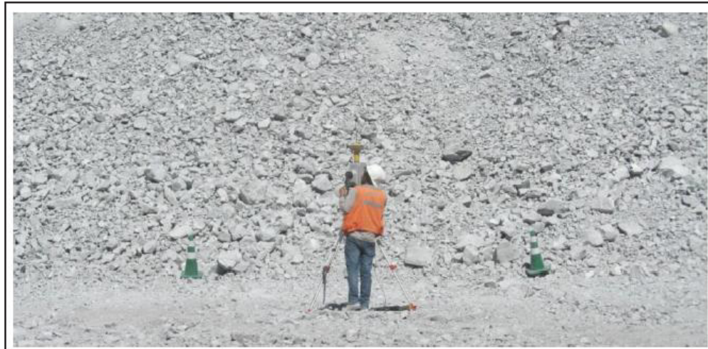
Gambar III.11. Penempatan Alat Lasser Scanner Pada Pengambilan Data Muckpile
