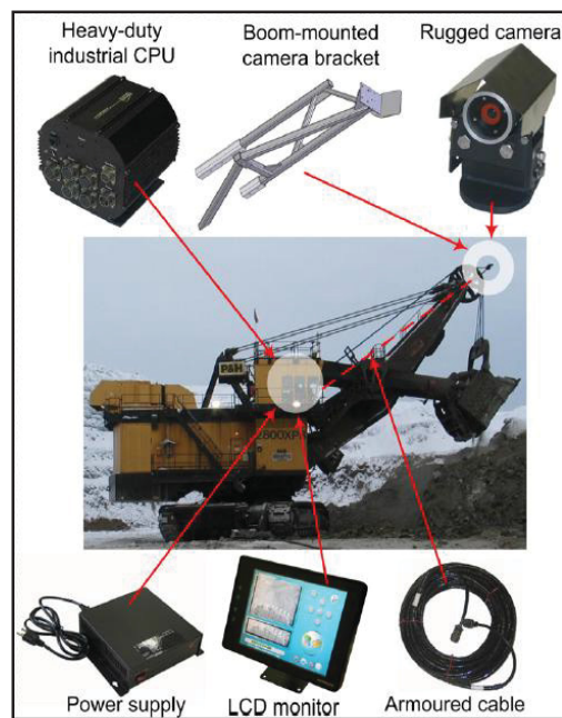
Gambar III.10. Perolehan Gambar Pada Shovel Yang Diterapkan Pada FragMetrics™
