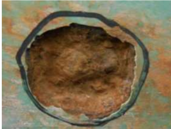
Gambar 2.18 Ilustrasi korosi lokal [12]
