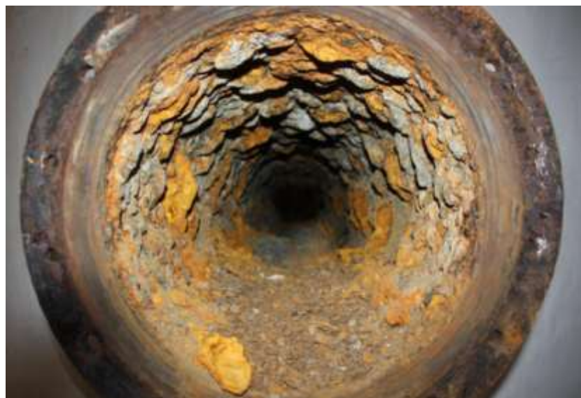
Gambar 2.21 Ilustrasi korosi erosi [15]
