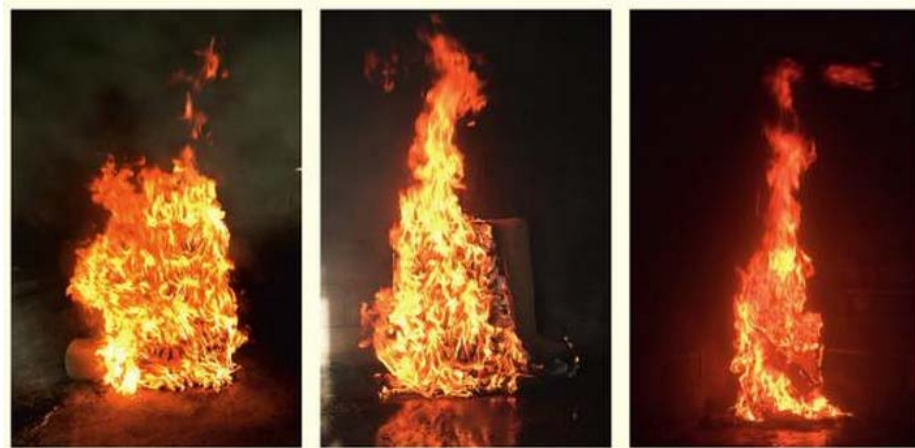
Gambar II.17 Efek lokasi sumber penyalan pada ruang terhadap ketinggian api. Penyalan di tengah ruang (kiri), penyalan di dekat dinding (tengah), dan penyalan di pojok (kanan).
